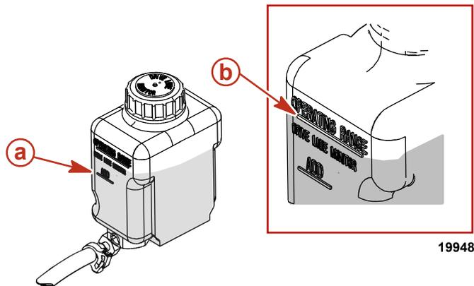
**Le niveau d'huile pour engrenages est dans la plage de fonctionnement correcte**
