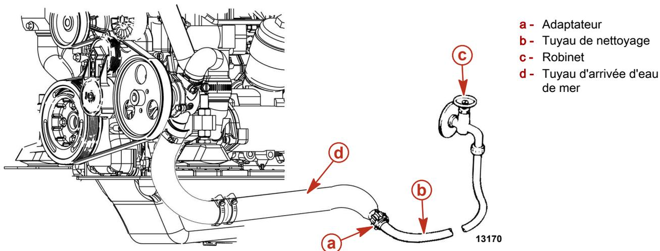
2. Pour le nettoyage du système d'eau de mer lorsque le bateau est à l'eau :
