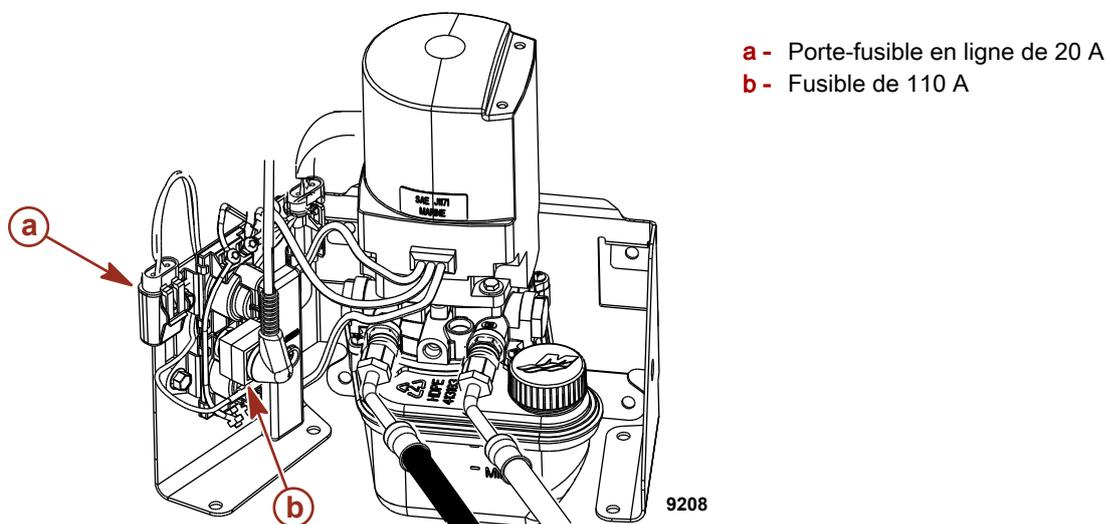
2. Plusieurs systèmes MerCathode Quicksilver différents sont disponibles. Chacun d'eux est doté d'un fusible raccordé à la borne positive (+) du contrôleur. Si ce fusible est grillé, le système n'assure pas sa fonction de protection anticorrosion. Le remplacer par un autre de même intensité nominale.
